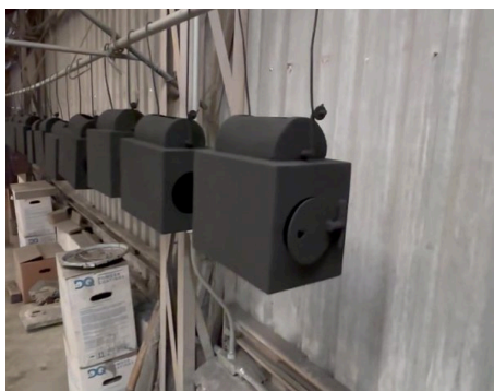
Pintura aplicada, antes del horno
